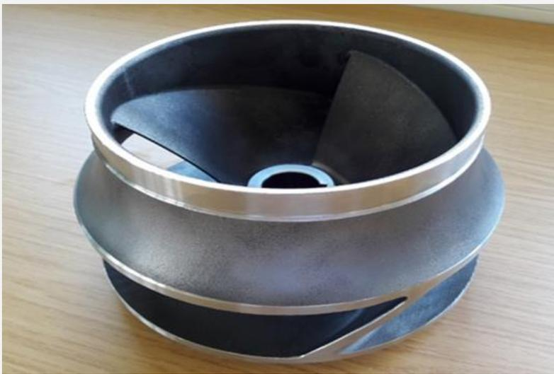
Lauftrad Prototyp Hydraulikentwicklung
